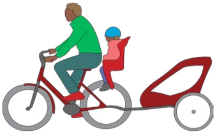
Largo: 2.98 m Ancho: 0.70 m Esquema 42. Bicicleta con remolque
